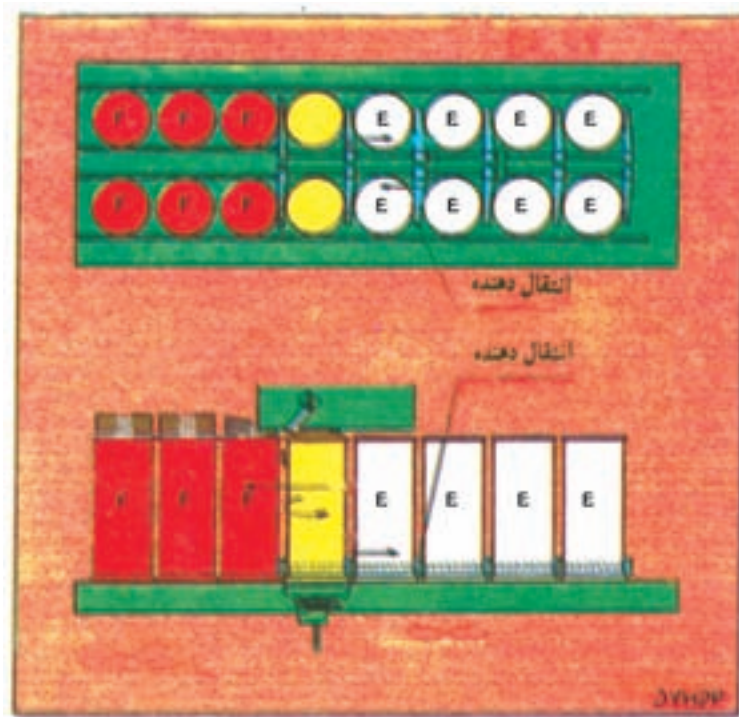
شکل ۱۱-۴ - نمایی از انتقال الیاف از کالندر تا بانکه
