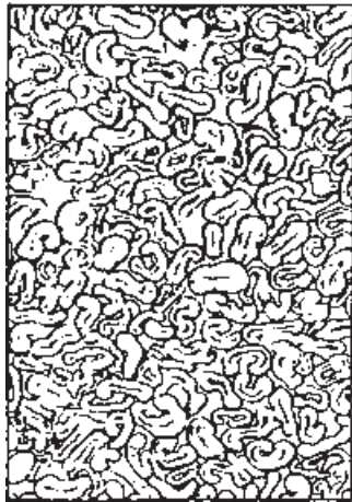
مقطع عرضی الیاف مرسیزه نشده
