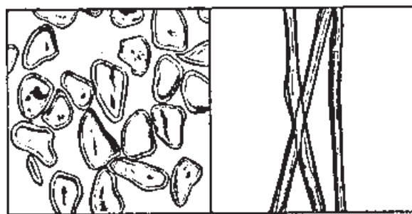
شکل ۱۵-۳- نمای طولی و مقطع عرضی ابریشم
