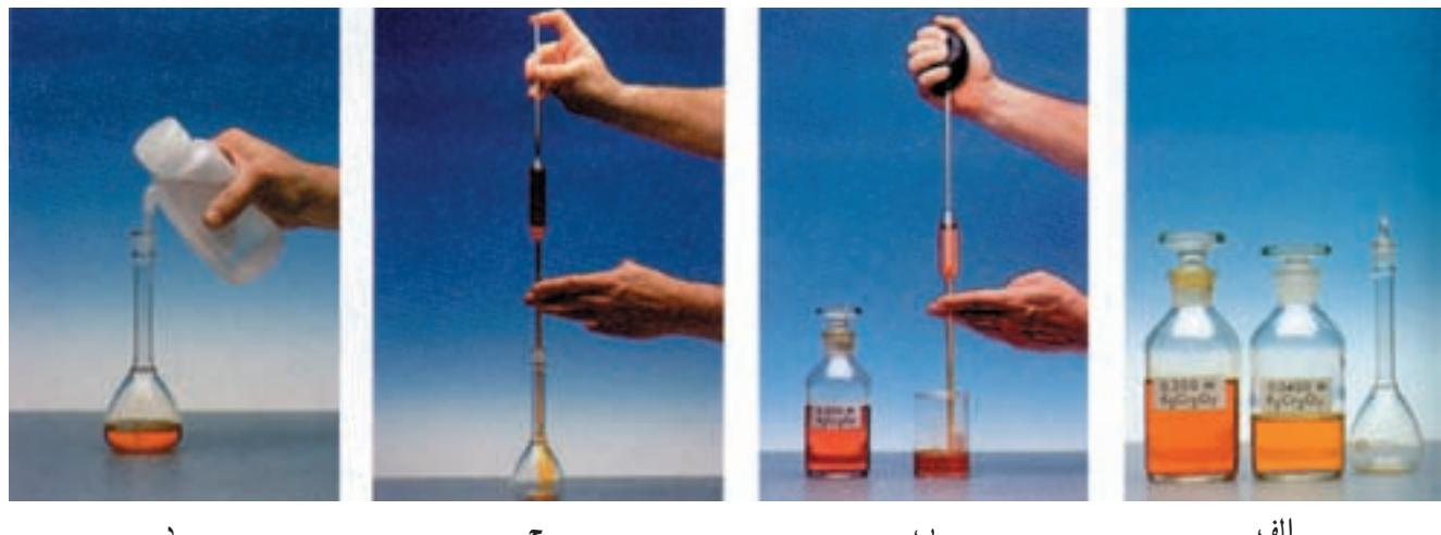
شکل ۱-۱۰- تهیه محلول ۱N پتاسیم دیکرومات از محلول ۱N آن
