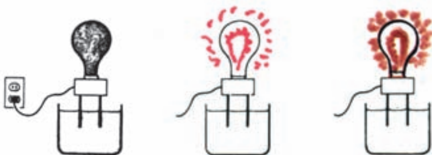
محلول ۰/۲ مولار شکر محلول ۰/۲ مولار استیک اسید محلول ۰/۲ مولار هیدروکلریک اسید جراغ خاموش (غیر الکترولیت) چراغ کم نور چراغ پر نور
