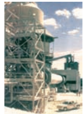
شکل ۸-۹- یک کارخانه مدرن آهک‌پزی: کوره مدرن تبدیل سنگ آهک به آهک در صنایع شیمیایی از اهمیت فراوانی برخوردار است. این ماده ارزان‌ترین باز به‌شمار می‌رود. در تهیهی بسیاری از مواد شیمیایی، هم چنین تهیهی مصالح ساختمانی، از جمله سیمان و شیشه به‌کار می‌رود. واکنش تهیهی آن در دمای بالا و در کوره‌ی چرخان بزرگی انجام می‌گیرد که ابعاد آن ممکن است به 15^{\circ} متر و قطر 5 متر برسد.
