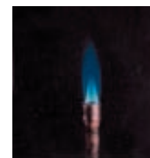
ب) یک چراغ پونزن با شعله آبی که در آن فرآیند سوختن گاز به طور کامل انجام می‌شود.
