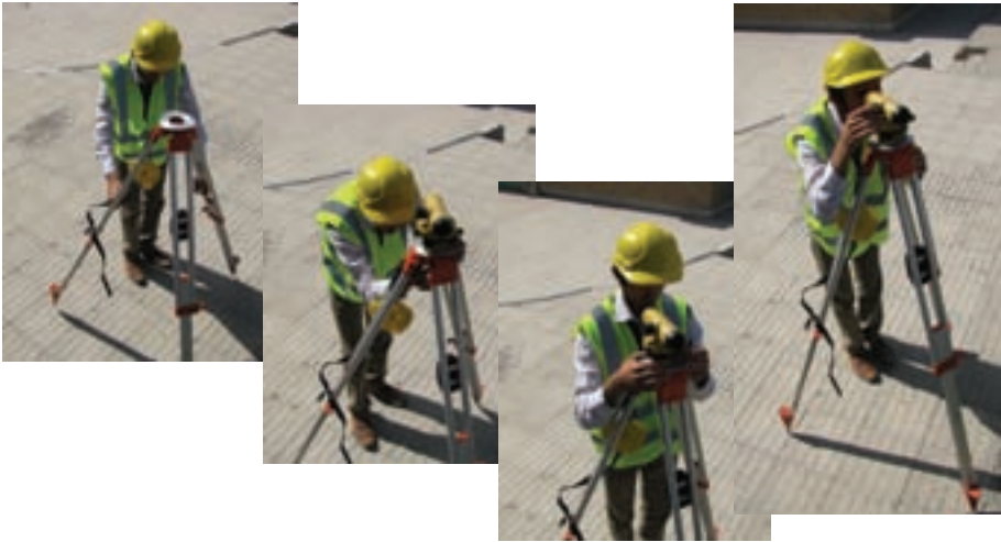
شکل ۱۱ - ۷. مراحل استقرار دوربین تراز یاب
