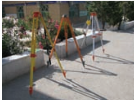
شکل ۱۱ - ۲. انواع سه پایه تراز یاب
