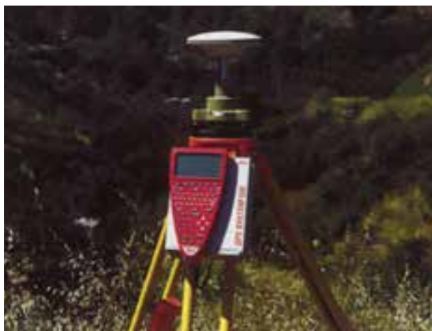
شکل ۷-۵- چند نمونه گیرنده‌های دقیق تعیین موقعیت ماهواره‌ای (GPS)
