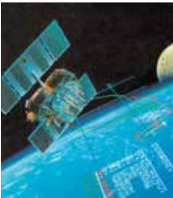
شکل ۴-۵- هر ماهواره دارای یک فرستنده، یک گیرنده، یک آنتن، یک میکروپروسسور و ۱۵ سیلاتور است.
