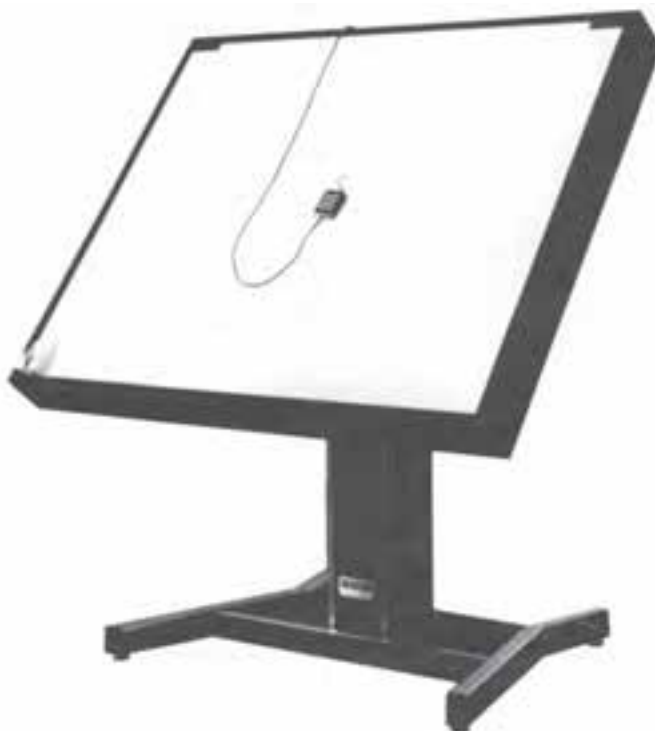
شکل ۲۶-۴- یک نمونه دیجیتالیزر در اندازه A°
