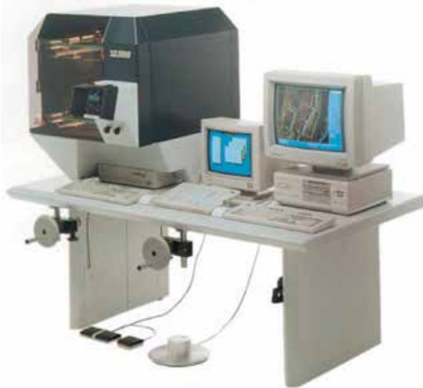
شکل ۱۰-۳- دستگاه تحلیلی تبدیل عکس به نقشه
