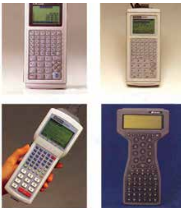
شکل ۲۰-۴ نمونه‌هایی از تجهیزات ثبت اطلاعات صحرائی (فیلدبوک)
