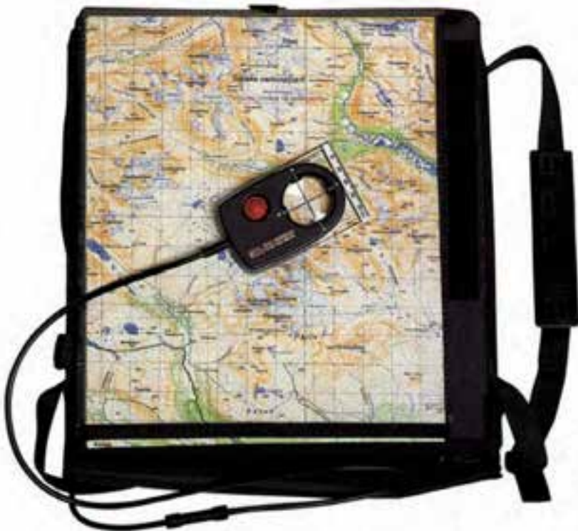
شکل ۴-۲۵- یک نمونه دیجیتایزر در اندازه A^3
