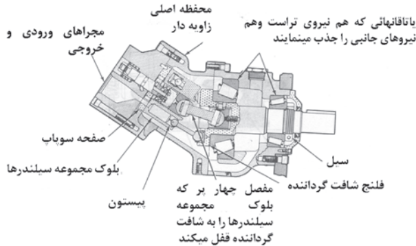
شکل ۳۲-۹- پمپ‌هایی پیستونی محور- زاویه‌دار
