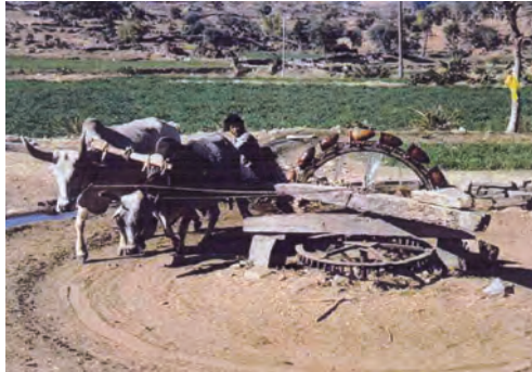
شکل ب-۹- ابداع مکانیزم پمپاژ آب ساکن به سطح
