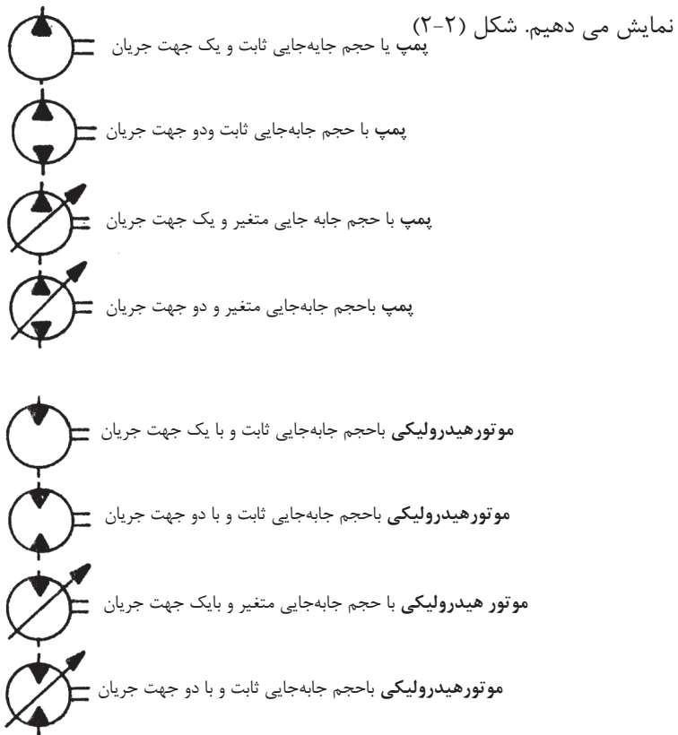
شکل ۲-۲- نمادگرافیکی هیدروپمپ‌ها و هیدروموتورها
