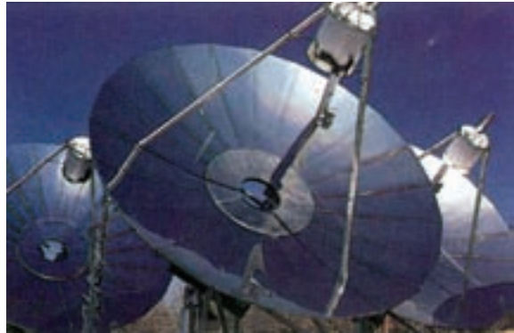
شکل ۴-۳ کوره‌ی آفتابی که با آن می‌توان انرژی تابشی خورشید را به انرژی گرمایی تبدیل کرد.
