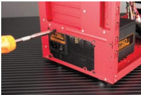
شکل ۸-۲ نصب منبع تغذیه و ثابت کردن آن
