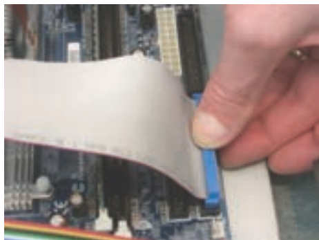
شکل ۸-۲۲ نصب کابل IDE
