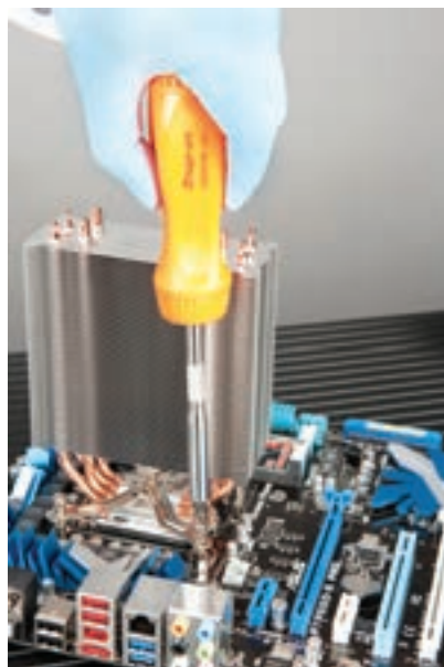
شکل ۸-۸ نمونه‌ای از نصب پایه‌ی خنک‌کننده
