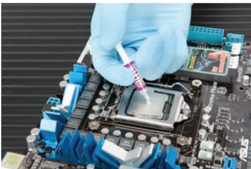
شکل ۸-۷ پوشاندن پردازنده با خمیر انتقال حرارت
