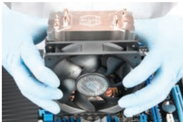
شکل ۸-۹ نصب خنک‌کننده‌ی پردازنده
