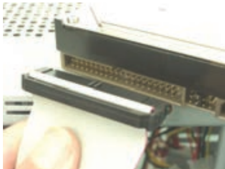
شکل ۸-۲۲ نصب کابل IDE
