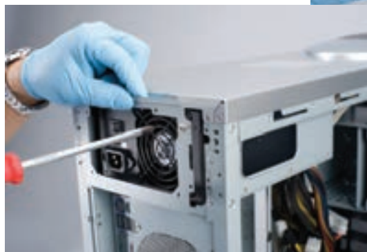
شکل ۸-۳ نصب پروانه‌ی خنک‌کننده‌ی کیس
