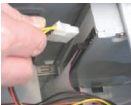
شکل ۲۳-۸ اتصال کابل برق دیسک گردان نوری
