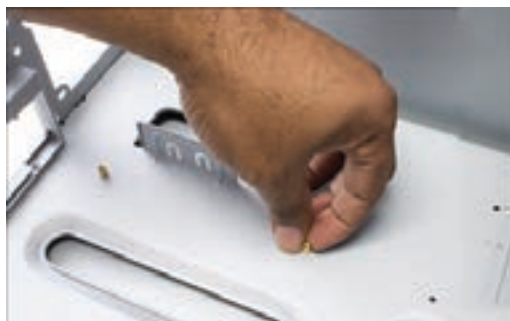
شکل ۸-۱۲ ثابت کردن پایه‌های برنجی
