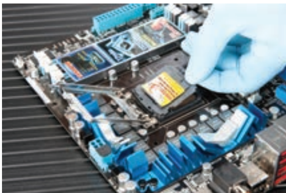
شکل ۴-۸ برداشتن پوشش محافظ سوکت پردازنده
