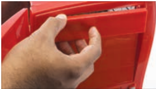
شکل ۲۰-۸ برداشتن پانل جلوی کیس
