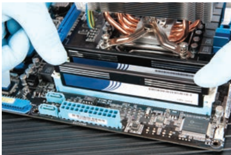
شکل ۸-۱۱ استقرار ماژول حافظه در شکاف حافظه
