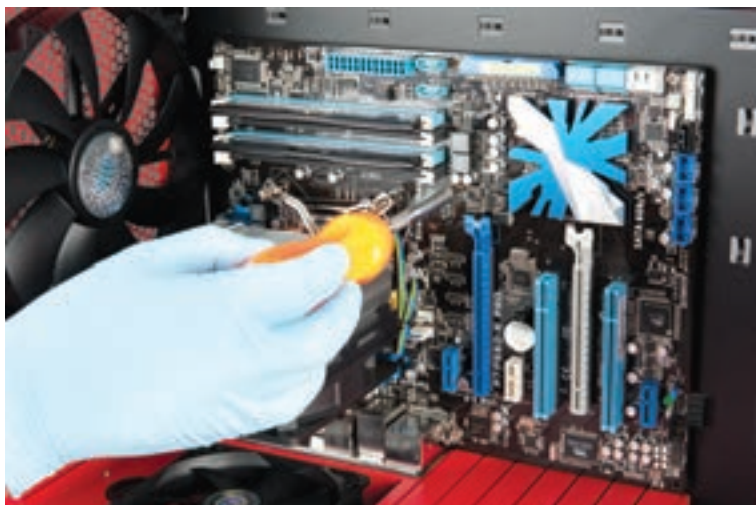
شکل ۸-۱۵ بستن پیچ‌های برد اصلی
