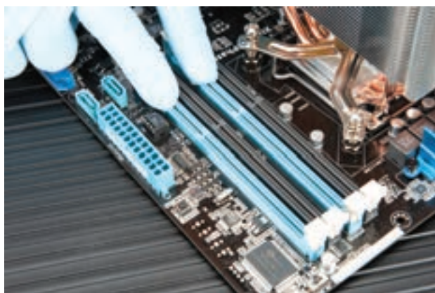
شکل ۸-۱۰ هماهنگ کردن فرورفتگی ماژول حافظه با برآمدگی شکاف حافظه
