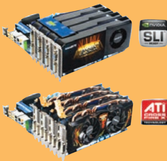
شکل ۲۵-۸ نصب کارت‌های گرافیک CrossFire و SLI
