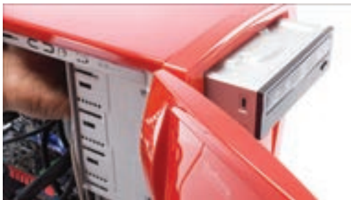
شکل ۸-۲۱ استقرار دیسک گردان نوری
