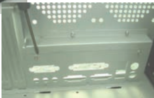
شکل ۸-۱۳ نصب پانل ورودی/خروجی
