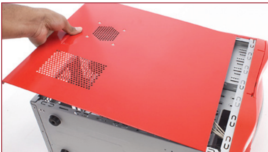
شکل ۸-۱ برداشتن قاب‌های جانبی
