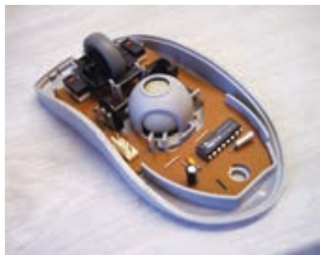
شکل ۲۷-۶ درون ماوس مکانیکی - نوری
