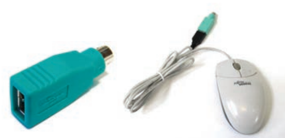
شکل ۲۹-۶ تبدیل USB به رابط PS/2 برای ماوس
