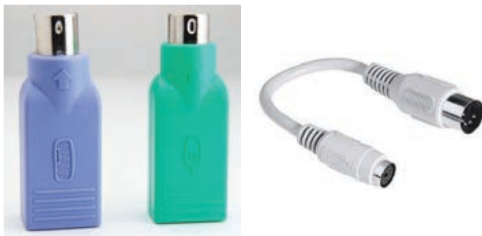
شکل ۲۳-۶ سمت راست، تبدیل کننده‌ی DIN پنج پین به PS/2 و سمت چپ، تبدیل کننده‌ی رابط USB به رابط PS/2 برای صفحه کلید و ماوس
