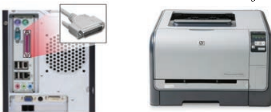
شکل ۱۸-۶ چاپگر لیزری HP Laser Jet ۱۵۱۵ (سمت راست)، محل اتصال درگاه موازی LPT (سمت چپ)
