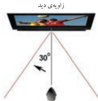
شکل ۸-۶ بهترین کیفیت تصویر برای این LCD، از دید عمود کاربر و تا زاویه‌ی ۳۰ درجه
