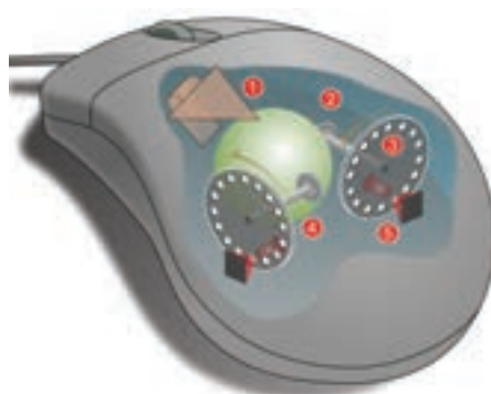
شکل ۲۷-۶ درون ماوس مکانیکی - نوری
