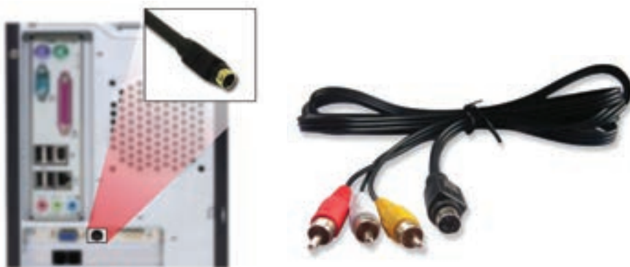
شکل ۵-۱۱ کانکتور (S-Video) به رنگ مشکی و کانکتورهای رنگی دیگر، جهت اتصال به تلویزیون
