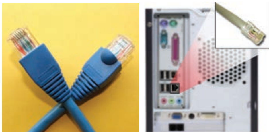
شکل ۵-۳۶ اتصال دهنده‌ی کابل شبکه در پشت کیس و سر کابل آن
