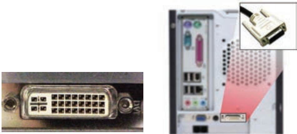
شکل ۵-۱۷ درگاه DVI برای اتصال به صفحه‌نمایش‌های دیجیتال
