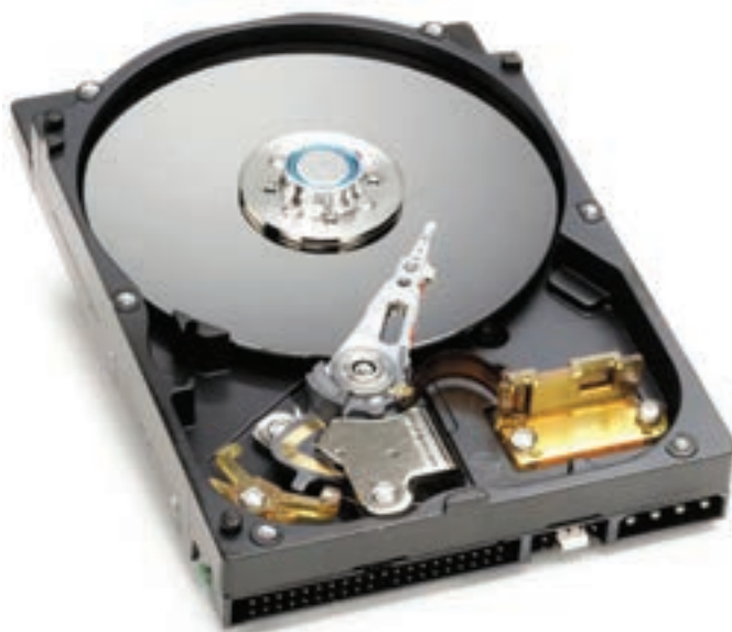
شکل ۲۹-۴ نمای داخلی دیسک سخت
