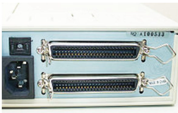
شکل ۴-۴۶ کانکتور اسکازی روی دیسک سخت خارجی
