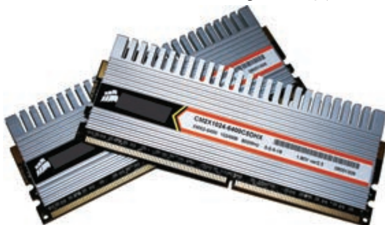
شکل ۱۷-۴ حافظه ی اصلی DDR2 با ظرفیت یک گیگابایت و فرکانس پالس ساعت ۸۰۰ مگاهرتز
