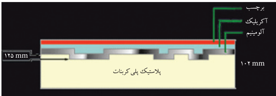
شکل ۴-۳۶ لایه های دیسک فشرده
