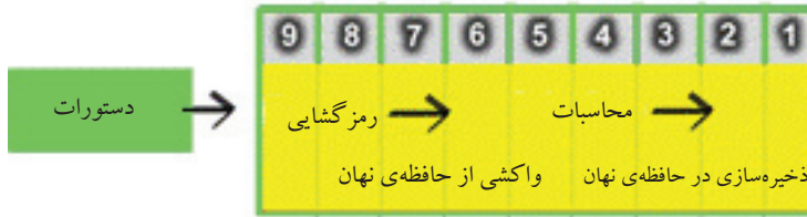
شکل ۱۵-۳ پردازش با استفاده از خط لوله
