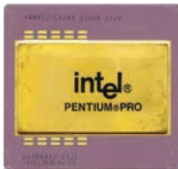
شکل ۳-۳۲ جلو و پشت پردازنده ی پنتیوم پرو با فرکانس ۲۰۰ مگاهرتز
