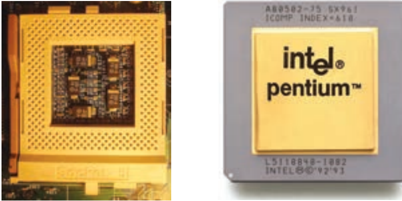
شکل ۳-۳۰ پردازنده ی پنتیوم ۷۵ و سوکت شماره ی ۵
