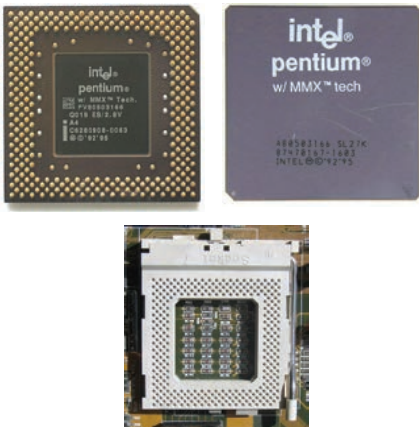
شکل ۳-۲۱: نمای جلوی و پشت پردازنده‌ی پنتیوم MMX ۱۶۶ و سوکت شماره‌ی ۷
