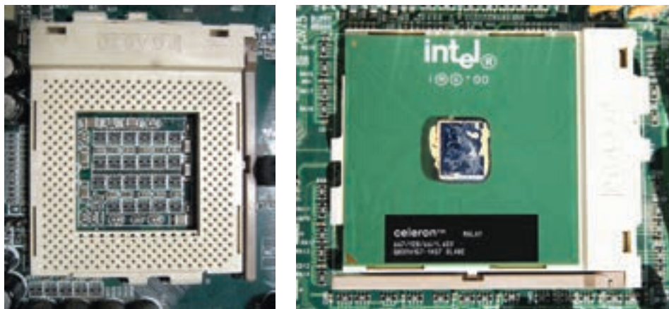
شکل ۳-۳۴ پردازنده‌ی سلرون و سوکت ۳۷۰ PGA
