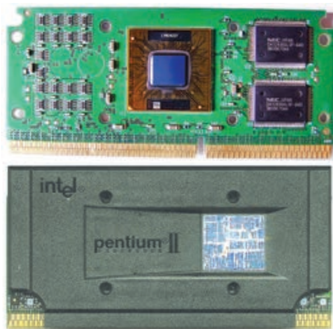
شکل ۳-۳۳ پشت و جلو پردازنده‌ی پنتیوم II با دو تراشه‌ی حافظه‌ی نهان و به صورت شکاف ۱
