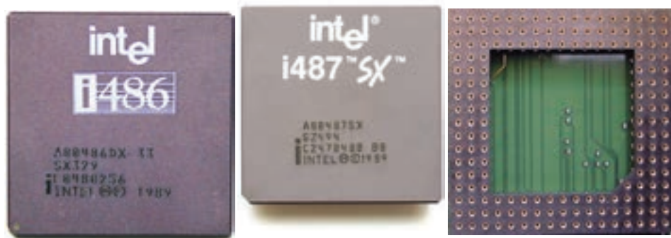
شکل ۲۲-۳ پردازنده ی ۸۰۴۸۶ DX محصول شرکت اینتل با فرکانس پالس ساعت ۳۳ مگاهرتز، کمک پردازنده ی اولیه ی ۸۰۴۸۷ و سوکت شماره ی یک
