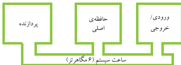
شکل ۲-۲۳ گذرگاه واحد در رایانه‌های اولیه، نسل XT، ساختار اصلی یک گذرگاه و با یک سرعت معین
