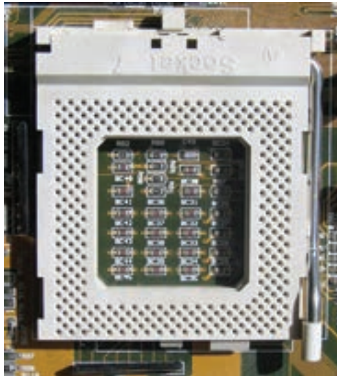
شکل ۲-۷ سوکت پردازنده از نوع ZIF
