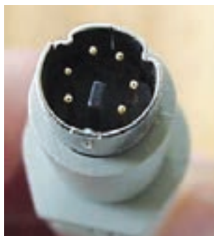
شکل ۱۲-۲ اتصال دهنده ی PS/2، سر کابل صفحه کلید
