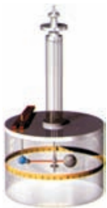
شکل ۲-۲۰- ترازوی پیچشی کولن
