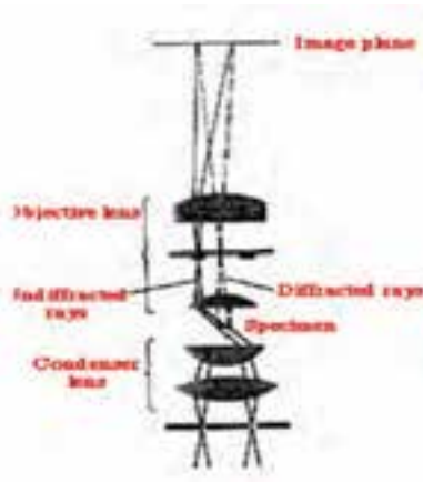
شکل ۳۳-۲- سمت چپ، میکروسکوپ فاز متضاد و سمت راست، چگونگی تشکیل شکل توسط میکروسکوپ متضاد
