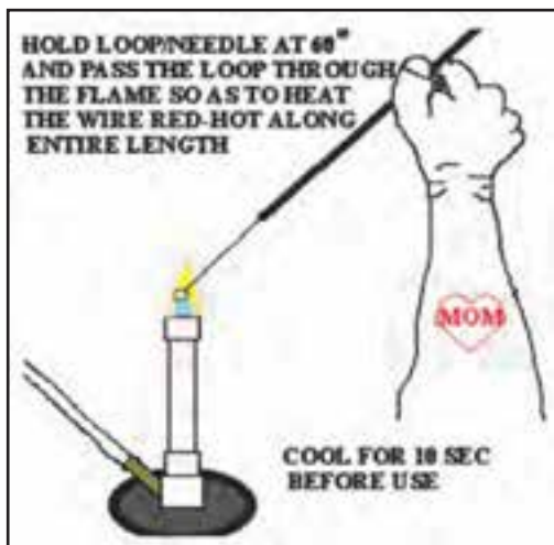
شکل ۲۲-۲- روش سترون کردن حلقه و سوزن کشت
