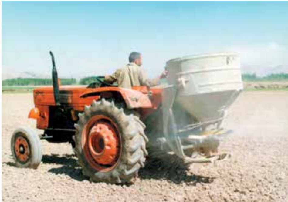
شکل ۸-۴- پخش کود شیمیایی به وسیله کودپاش ساتریفورژ
