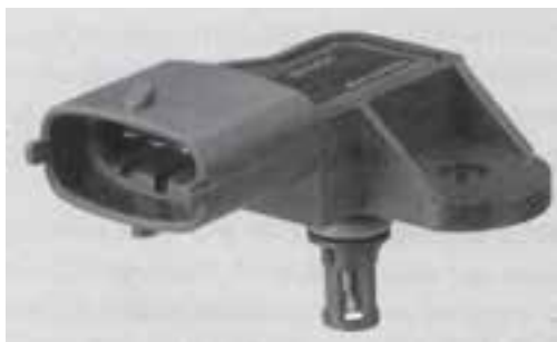
شکل ۲-۷۱- حسگر شار میکرومکانیکال با محفظه‌ی خلأ مرجع و حسگر حرارت
