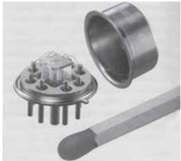
شکل ۶۷-۲- المنت حسگر اندازه‌گیر فشار با درپوش و خلا مرجع داخلی
