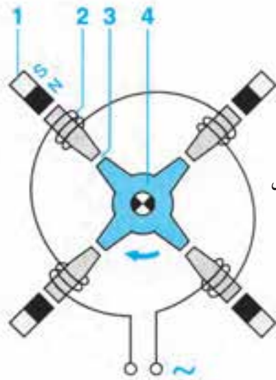
شکل ۴۳-۲ حسگر نوع القایی در توزیع کننده‌ی جرقه
