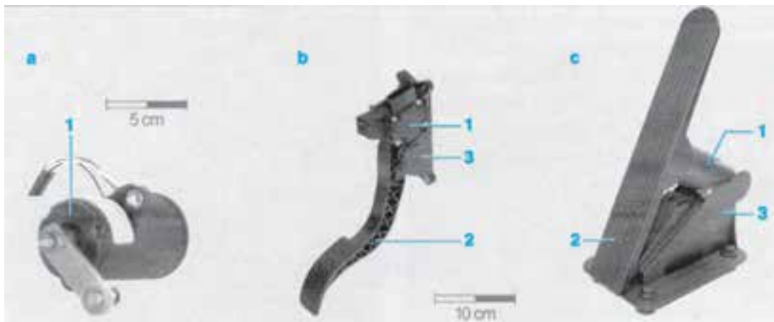
۱- حسگر ۲- پدال گاز ۳- پایه‌ی پدال a- حسگر پدال گاز b- پدال گاز معلق c- پدال گاز مستقر در کف
