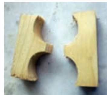
شکل ۳- ج، نمونه آزمایش کشش عمود بر الیاف پس از شکسته شدن.
