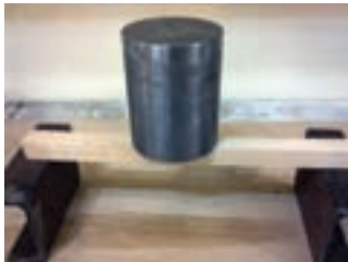
شکل ۷-۱۶ در این آزمایش جهت الیاف موازی با جهت طولی نمونه می‌باشند.
