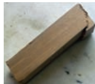
شکل ۶-۶- نمونه‌های چوبی شکسته شده در اثر بارهای فشاری و کششی
