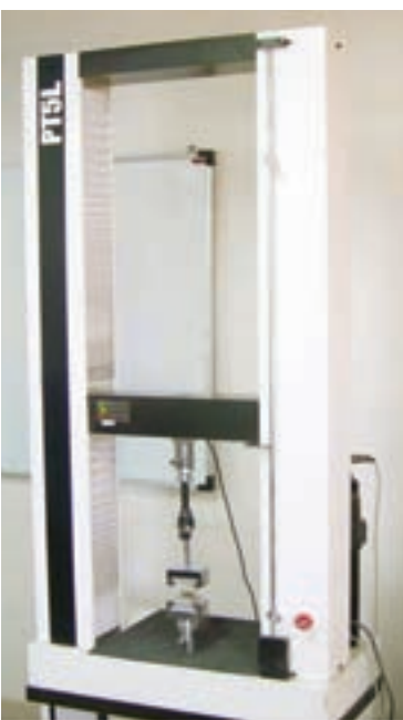
شکل ۱۱-۶، یک نمونه دستگاه مکانیکی کشش و فشار (تستینگ)، ظرفیت این دستگاه در حدود ۱ تن و انتقال نیرو از موتور به بخش متحرک به وسیله میله مارپیچ می‌باشد.
