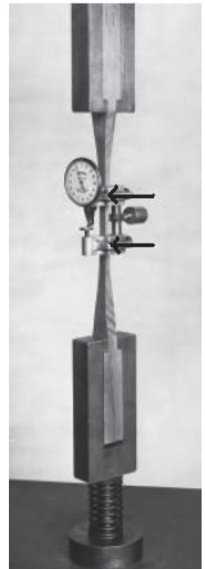
شکل ۶-۲۴، کرنش سنج نصب شده به نمونه چوبی در حال کشیده شدن
