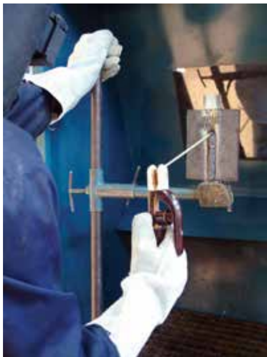
شکل ۱۰-۱۱- کمک‌گرفتن از دست در استقرار پایدار موقع جوشکاری سربالا
