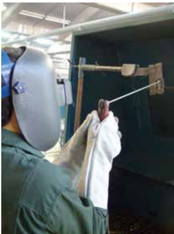
شکل ۱۱-۱۱- استفاده از دو دست در کنترل زوایا و طول قوس الکتروود به کار
