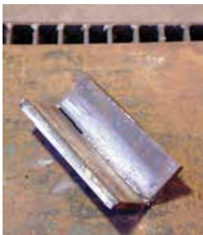
شکل ۱۴-۱۱- میزان نفوذ در جوشکاری زاویهی خارجی سربالا مشاهده می‌شود.
