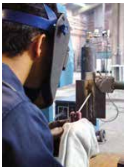
شکل ۱۶-۱۱- قوس جوشکاری به طرف قسمت جوش نخورده‌ی کار است و فلز جوش سریع سرد می‌شود.
