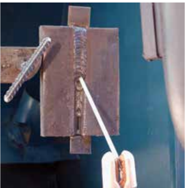
شکل ۴۰-۱۱- اجرای گرده جوش با نوسان کم در وضعیت سرازیر
