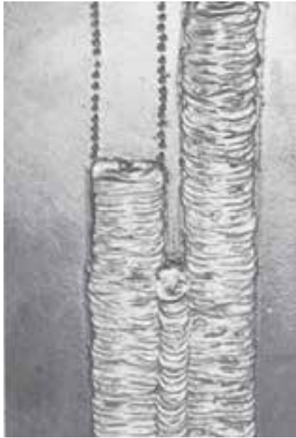
شکل ۲۲-۱۱- جوشکاری گرده جوش از پایین به بالا
