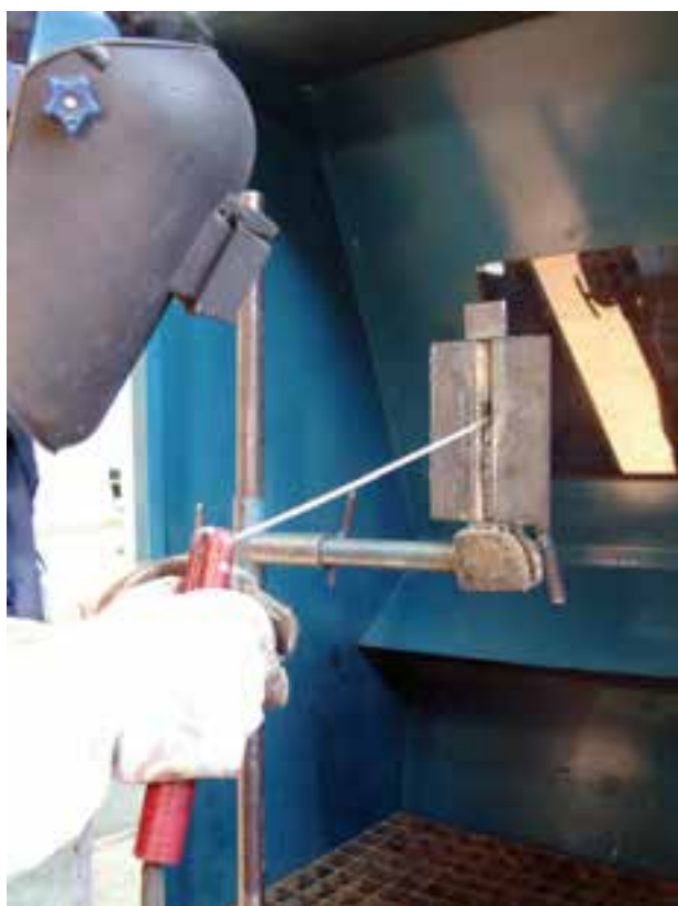
شکل ۱۱-۷- جوشکاری با قطب DCRP
