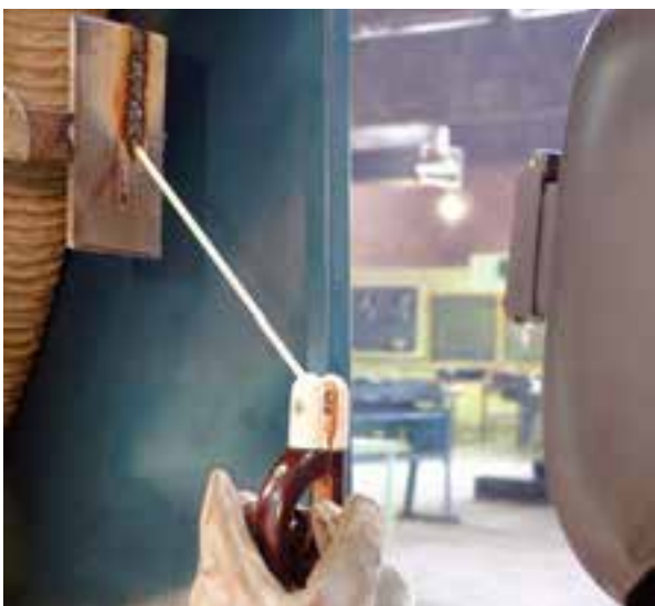
شکل ۳۹-۱۱- چگونه حالت دست و انبر جوشکاری در جوشکاری سرازیر
