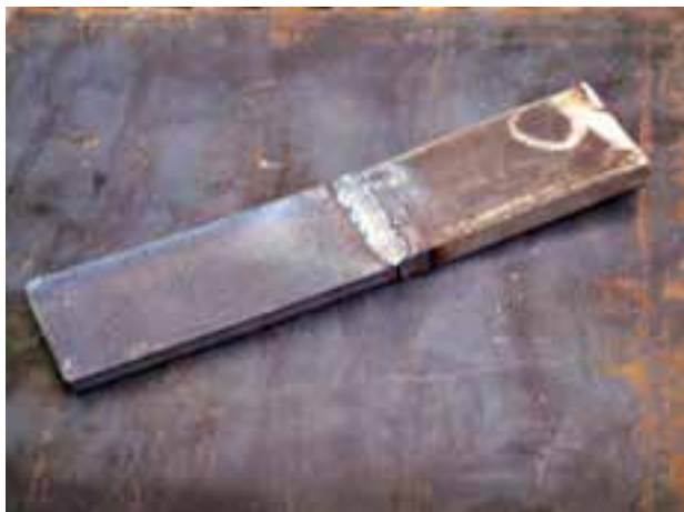
شکل ۱-۱- پیچیدگی در اثر جوشکاری بدون مهار
