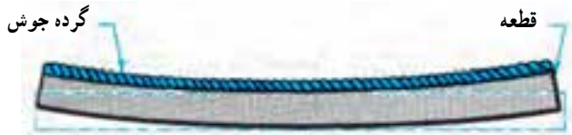
شکل ۸-۱ پیچیدگی طولی را نشان می‌دهد. شکل که با خط چین قبل از جوشکاری را نشان می‌دهد.
