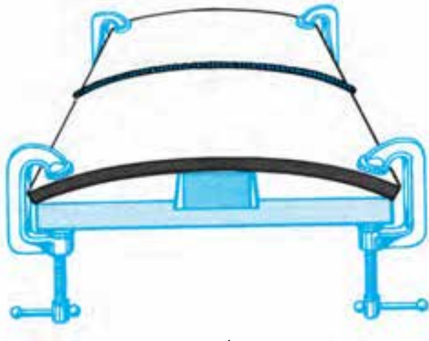
شکل ۱۹-۱- خمیدگی موقتی برای جوشکاری
