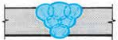
شکل ۱۰-۲۵-۱- ترتیب جوش‌دادن برای جلوگیری از پیچیدگی
