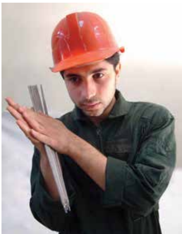
شکل ۹-۲۱- امتحان خشک بودن الکترودها
