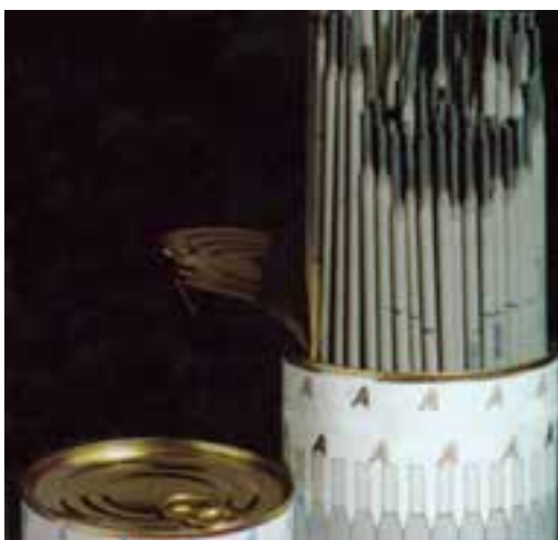
شکل ۱۷-۹- بسته‌بندی روپوش الکتروود
