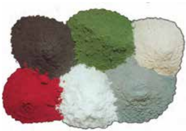
شکل ۱۶-۹- پودرهای تشکیل دهنده‌ی روپوش
