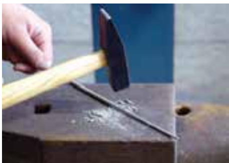
شکل ۹-۵ حذف روپوش الکتروود
