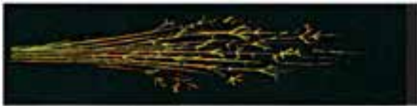
فولاد ابزار با ۱ درصد کربن C100 جرقه زیاد انتهای ستاره‌ای اثرگذار کربن 1.0C.25Si-0.25Mn شکل ۸-۹
