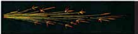
فولاد تکمیلی یا ۰/۴۵ درصد کربن C45 جرقه زرد رنگ با انتهای ستاره‌ای خاری تأثیرگذار کربن 045c.0.25si-065Mn
