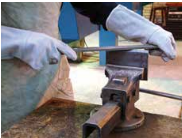
شکل ۸-۲- آزمایش براده‌برداری با سوهان
