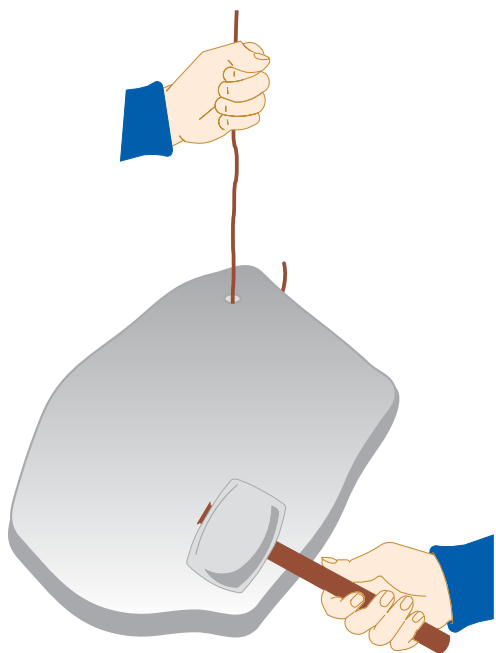
شکل ۱۳-۸- چگونگی آزمایش صدای قطعه‌ی چدنی
