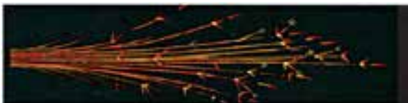
فولاد فنر 0.45C 45CrMnV67 جرقه نارنجی و نازک با نوک تیز نیزه‌ای تأثیرگذار کربن و مولیبدن 0.45C:0.25Si: 1.4Cr 0,7Mn1.4Cr
