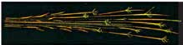
فولاد ابزار آلیاژی 60MnSi4 جرقه زرد تأثیرگذار کربن و سیلیسیم 0,6C-1.0Si-10Mn
