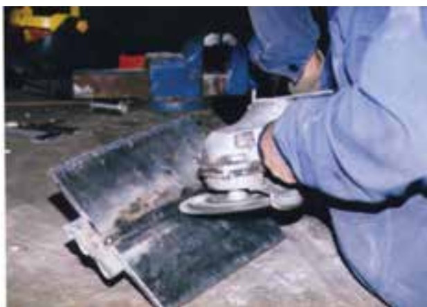
شکل ۷-۲- ب- برس زدن سطح قطعه با برس سیمی که برای دستگاه سنگ سنباده بسته شده است.
