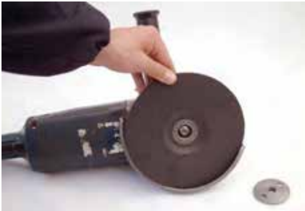
شکل ۷-۸- نصب و کنترل صفحه سنگ
