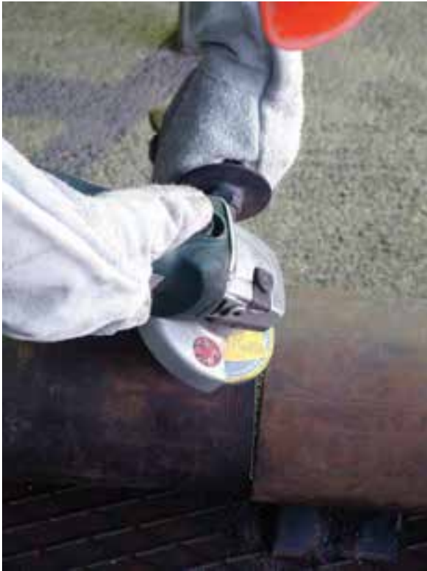
شکل ۱۰-۷- چگونه در دست گرفتن سنگ سنباده‌ی دستی کوچک
