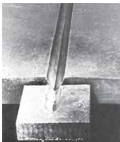
شکل ۶-۶۱- شیار حاصل از Goging
