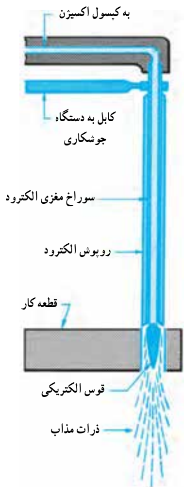
شکل ۶-۶۴- چگونگی برش قوسی با اکسیژن
