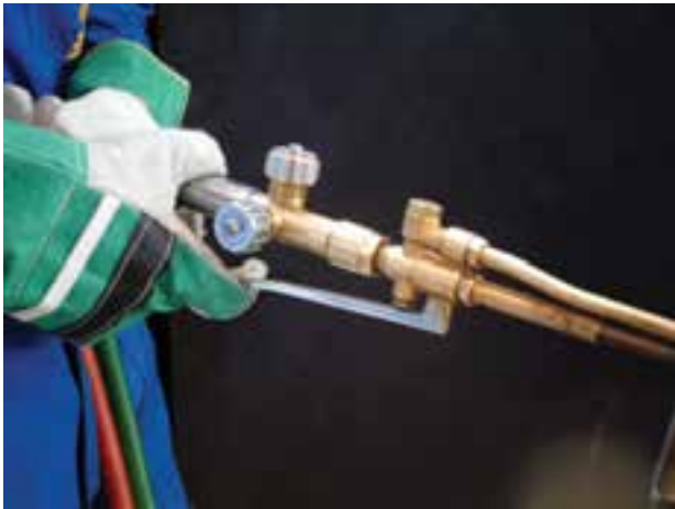
الف - با باز کردن اکسیژن طول شعاع سفید اول نباید تغییر کند.
