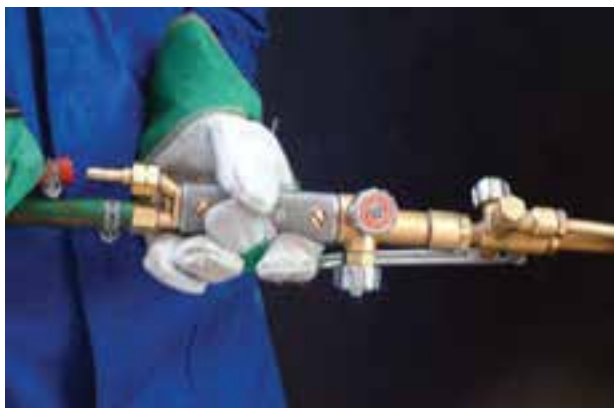
شکل ۳۲-۶ بستن شیلنگ استیلن به مشعل
