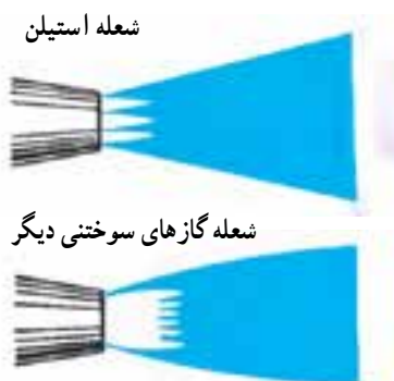
شکل ۱۳-۶- شعله‌ی گاز استیلن در مقایسه با گازهای سوختنی دیگر در برشکاری
