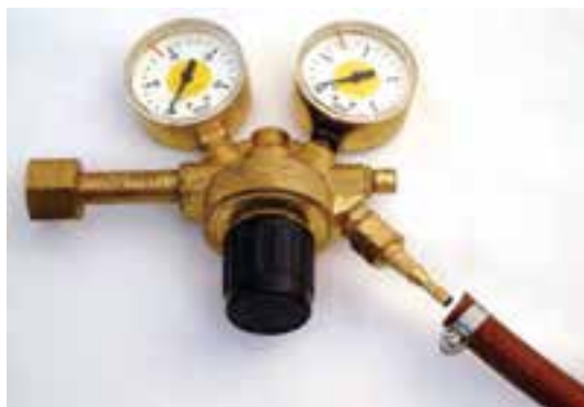
شکل ۲۹-۶ بستن شیلنگ به رگولاتور
