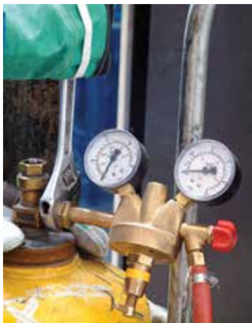
شکل ۲۸-۶ بستن رگولاتور به کپسول
