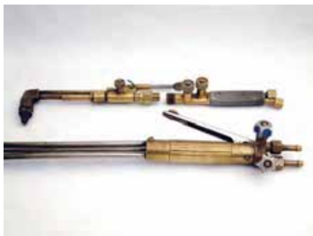
شکل ۶-۸- دو نوع مشعل برشکاری
