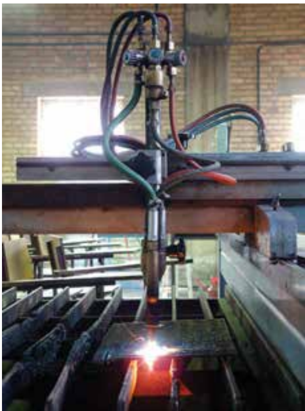
شکل ۳-۶- شعله اکسی استیلن در برشکاری
