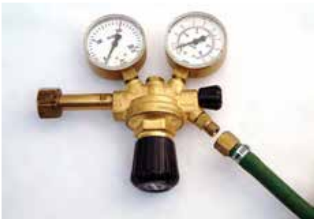
شکل ۳۰-۶ بستن شیلنگ اکسیژن به رگولاتور
