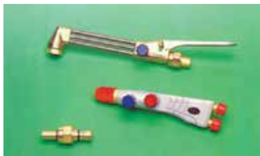
شکل ۵-۶- مشعل برشکاری که به دسته‌ی مشعل جوشکاری بسته می‌شود.
