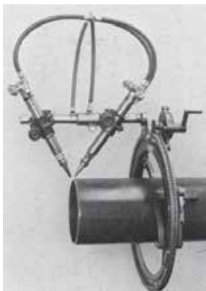
شکل ۱۹-۶- وسیله برشکاری و پیچ زنی لوله با شکل برش
