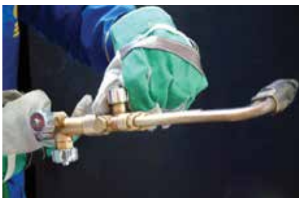
شکل ۳۳-۶ بستن شیر گاز در مشعل
