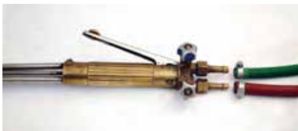
شکل ۳۱-۶ بستن شیلنگ‌ها به مشعل برشکاری
